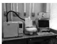
GC Shimadzu GC2010 Plus AF 2011年設置
